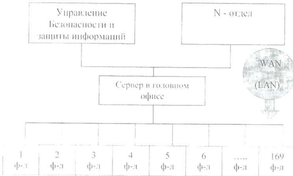
В каждый филиал устанавливается 8 камер видеонаблюдения и подключается к цифровому видеорегистратору. Все видеорегистраторы передают сигналы по локальной сети в серверный компьютер, установленный в головном банке, а сервер обрабатывает и записывает видеозаписи в жесткие диски и хранит их в течении одного месяца в архиве.
