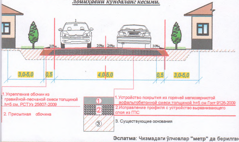
Асфальтобетон қопламали қишлоқ ички йўллارнинг лойиҳавий кўндаланг кесими.
