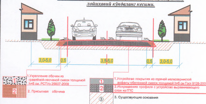
Асфальтобетон қопламали қишлоқ ички йўлларининг лойиҳавий кўндаланг кесими.
