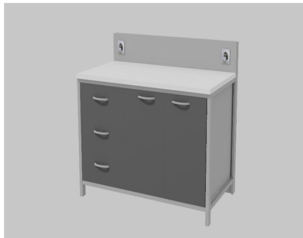
1. Металлокаркас изготовленный из профильной трубы сечением 50\*30мм с толщиной стенок 1,5мм. Профиль обрезается на ленточно отрезном станке под углами 45 и 90 градусов по необходимым размерам.
