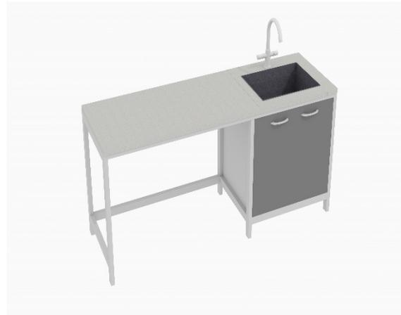
1. Металлокаркас изготовленный из профильной трубы сечением 50\*30мм с толщиной стенок 1,5мм. Профиль обрезается на ленточном отрезном станке под углами 45 и 90 градусов по необходимым размерам.
