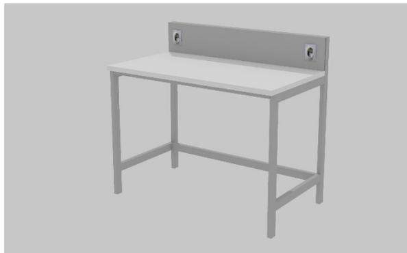
1. Металлокаркас изготовленный из профильной трубы сечением 50\*30мм с толщиной стенок 1,5мм. Профиль обрезается на ленточном отрезном станке под углами 45 и 90 градусов по необходимым размерам.
