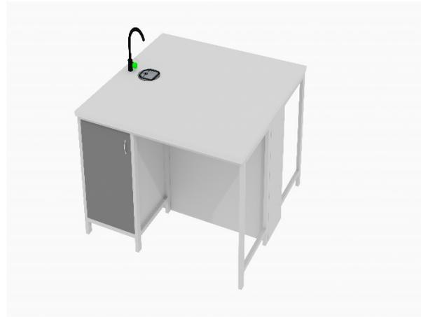
1. Металлокаркас изготовленный из профильной трубы сечением 50\*30мм с толщиной стенок 1,5мм. Профиль обрезается на ленточном отрезном станке под углами 45 и 90 градусов по необходимым размерам.
