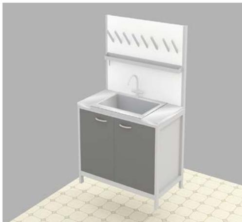
1. Металлокаркас изготовлен из профильной трубы сечением 50\*30мм с толщиной стенок 1,5мм.. Профиль обрезается на ленточном отрезном станке под углами 45 и 90 градусов по необходимым размерам.
