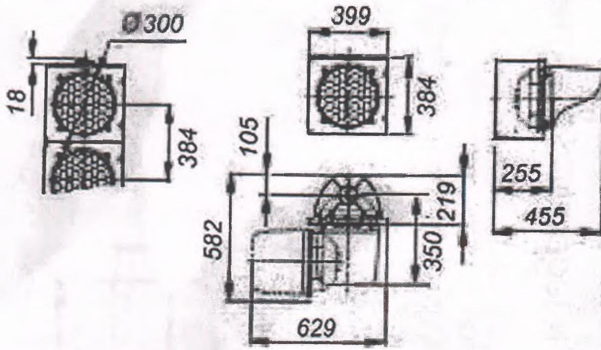
Габаритные размеры и внешний вид секции 300мм
