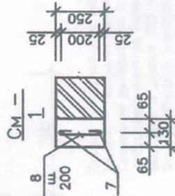
Сварку каркасов выполнять электродами типа Э-42А по ГОСТ 9467-75\*
