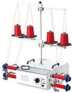
Машина для намотки нити на бабину. Перемотка для ниток на 4 бабины.
