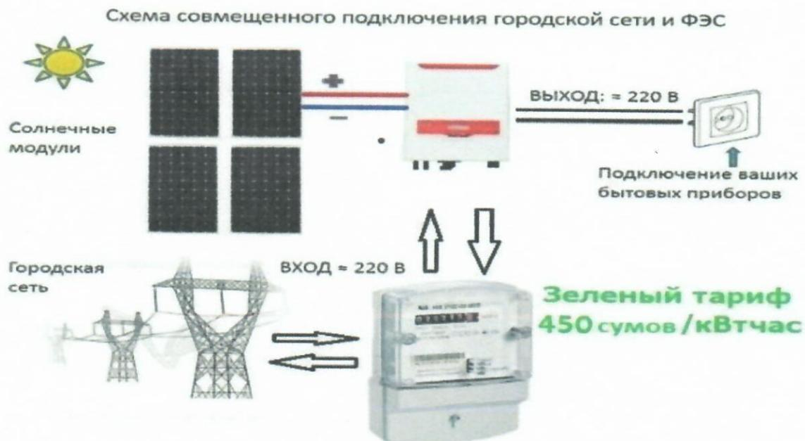
Этот тип СФЭС электропередач должна наиболее выгоден и электростанции такого типа работают совместно с обычной городской сетью электропередач:
