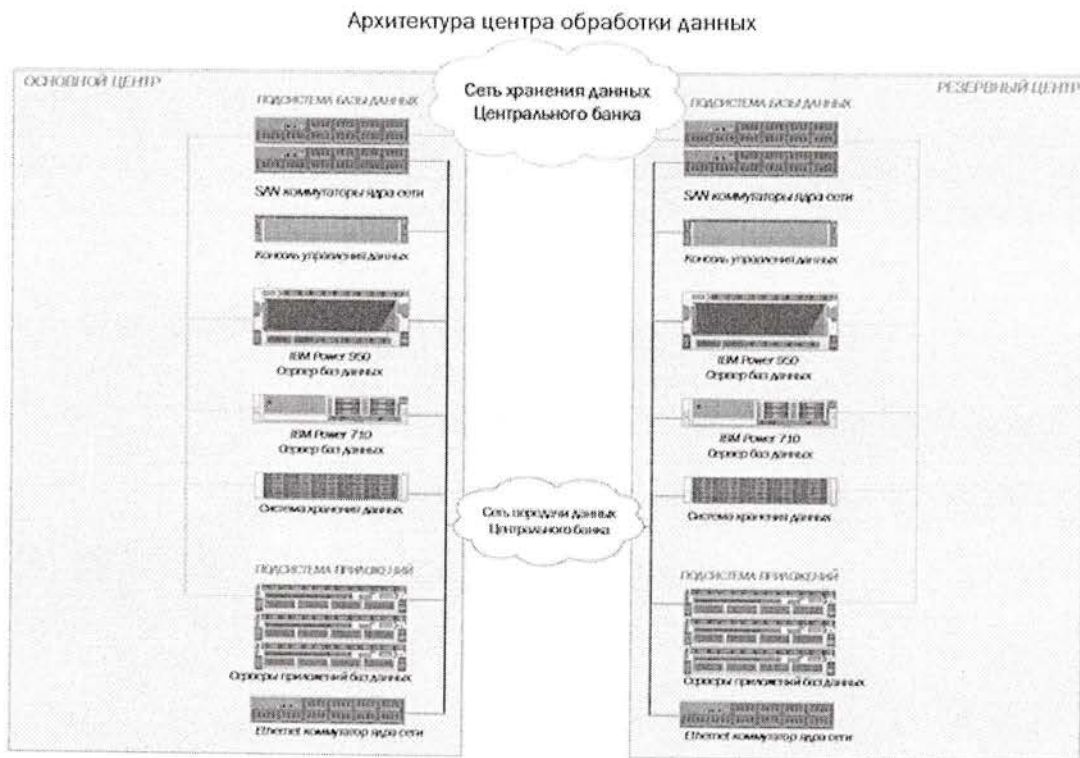
Рис 2. Логическая схема существующих Центров Обработки Данных ЦБРУ
