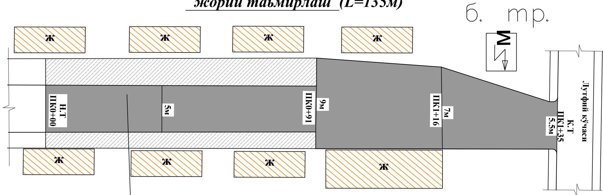
СРЕЗКА ПОВЕРХНОСТНОГО СЛОЯ АСФАЛЬТОБЕТОННЫХ ДОРОЖНЫХ ПОКРЫТИЙ МЕТОДОМ ХОЛОДНОГО ФРЕЗЕРОВАНИЯ ПРИ ШИРИНЕ БАРАБАНА ФРЕЗЫ 1000 ММ, ТОЛЩИНА СЛОЯ 5 СМ  $S=50 \times 5 = 250 \text{ м}^2$
