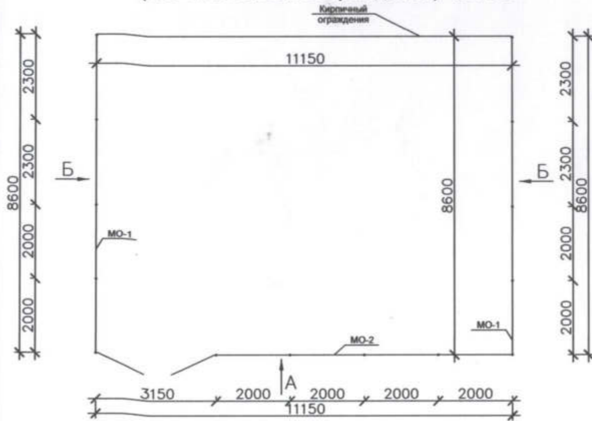
План металлическая ограждения (МО-1.2 Сетчатое ограждения) М1:100
